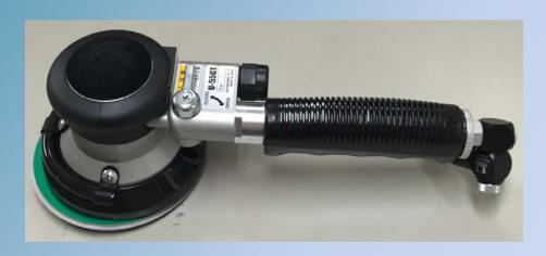
冷却エアホースの下部の 穴よりエアーが放出され 研磨面の温度が10℃以上 下がります。 作業時の回転を安定させる為に エアー量を固定できるスイング式 レギュレーターを採用。片手でも 楽々操作できます。 レギュレーター付ローターリー ソケットの採用で、エアホースの 取り回しが楽になり、手元でも 回転量を調整出来ます。
