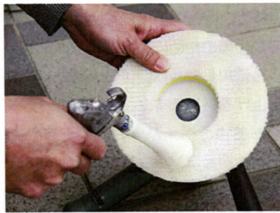
コンパウンドがこびり付いたウールバフ (左)。軽く湿らせた後にプラスチック製のブラシでこすり、少し乾かし振動エアガンなどでブローすれば (中央) 汚れが落ちる (右)
