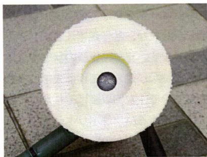
コンパウンドがこびり付いたウールバフ (左)。軽く湿らせた後にプラスチック製のブラシでこすり、少し乾かし振動エアガンなどでブローすれば (中央) 汚れが落ちる (右)
