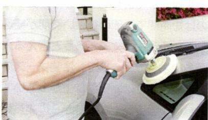
ピラーやフロントフェンダー先端など細い個所を磨く際は、バフが部分的にしか当たらず不安定になりますため、より強く脇を締め安定させる
