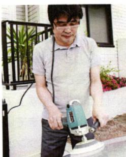
ハンドルの後ろ側を持ち、テコの原理を活用して最小限の力で動かしながら、しっかりと脇を締め、スイッチをロックボタンで固定すれば、安定してポリッシャーを操作できる
