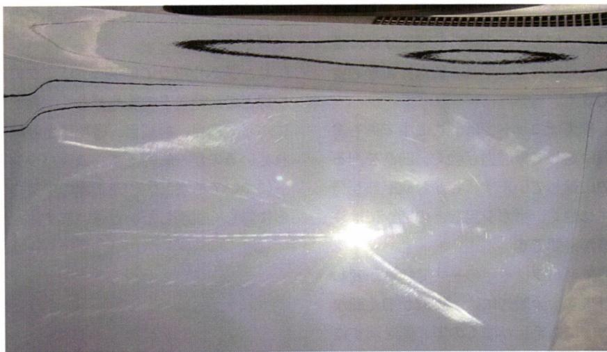
バフの移動した跡に沿って帯状に浮き上がったオーロラマーク。室内や曇り空では見えにくいものの洗車してコンパウンドなどの油分が落ちた後に太陽光などの強い光が当たれば現れるため注意が必要
