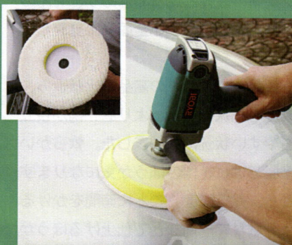
そのままポリッシャーを塗装面に置き、同じ場所で数秒間低速回転させ、コンパウンドをバフへ均一に馴染ませる
