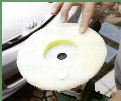
バフの縁から2cmほど内側に親指の爪くらいの大きさに3～4つ付け、指で軽くバフに擦り込む
