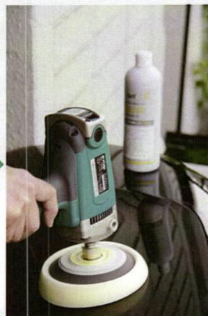
スポンジバフで磨いて完全に仕上げる。数時間後、濡れたクロスで拭き上げ、バフ目の戻りなどが発生していないことを確認したら、作業完了
