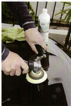
耐スリ傷性クリヤーに適したタイプの細目コンパウンドとミニバフを使用し、ゴミを取った後のペーパー目をピンポイントで磨く
