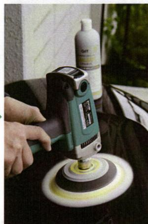
バフ目に戻ることを対策として、コンパウンドを超微粒子タイプに換え、仕上げ用の羊毛バフで磨く
