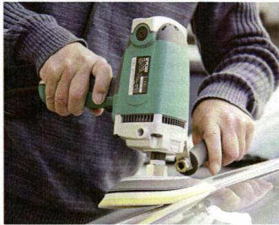
削りを意識した磨きでは、バフを平らに当てた後、ポリッシャーをハンドルで加圧しながら傾ける。この際はバフの片側が浮いても接地面は平らに当たるよう意識する
