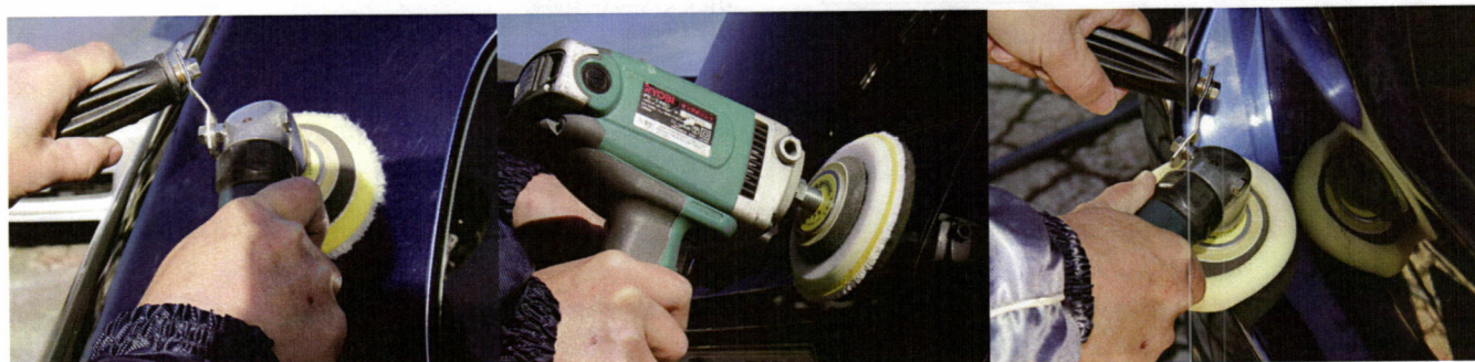
ピラーのボカシ際やバックドアなどの狭い場所、バンパーフェイスなどのエッジ部を磨く際は、コントロールしやすいサイズの小さなバフを用意し、作業時間短縮と仕上がりの品質向上を図る
