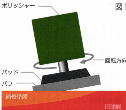
補修塗膜のボカシ際ではなく根元側に荷重をかけ、ポリッシャーを正回転させれば、ボカシ際のクリヤーはめくれにくい
