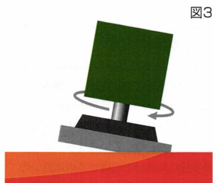
補修塗膜のボカシ際と旧塗膜に荷重をかけ、ポリッシャーを正回転させれば、膜厚の薄いボカシ際の塗膜がめくれる
