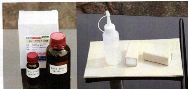
ボデーコーティング剤は瓶などに入れられていることが多い、一度に大量に出しあまいやすいため、小分けボトルに移し替えるのが安全。またスポンジも、そのまま使用せず仕上げ用クロスを巻き付けたほうが、コーティング剤を吸収しそうで適度に染み出しあやすい状態で残るため使用量を節約できる
