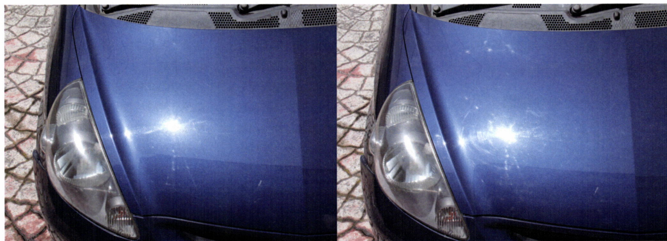
ツヤ出し剤入りのコンパウンドで磨いた直後(左)はきれいに仕上がったように見えるが、時間とともにツヤ出し剤が抜けてしまえば、隠されていた洗車傷が再び見えるようになる(右)
