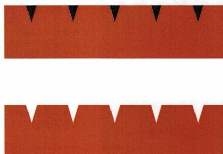
磨いた直後は傷がなくなったように見えても、洗車や脱脂、時間の経過で、埋まっていたコンパウンドの油分などが抜けるとペーパー目やバフ目が戻る可能性がある
