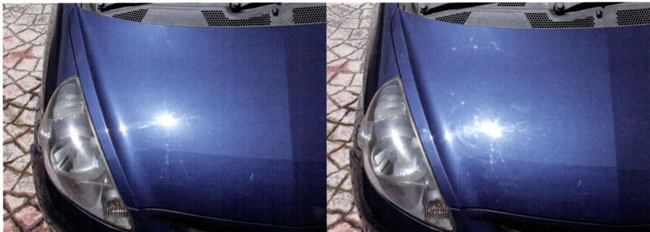
ツヤ出し剤入りのコンパウンドで磨いた直後（左）はきれいに仕上がったように見えるが、時間とともにツヤ出し剤が抜けてしまえば、隠されていた洗車傷が再び見えるようになる（右）
