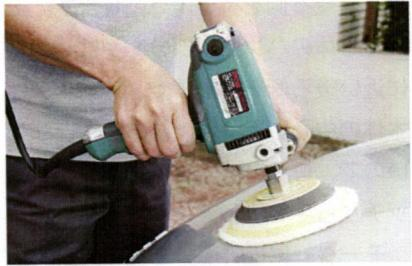
左右に移動させる時、動かしたい方向のハンドルを軽く押さえ、ポリッシャーを動かしたい方向に身体を傾けながら、脇を締め上腕部で操作すれば、長時間作業しても疲れにくい
