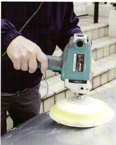
「削る」ための磨きでは、バフを斜めに強く当て、バフの角にトルクを集中させている
