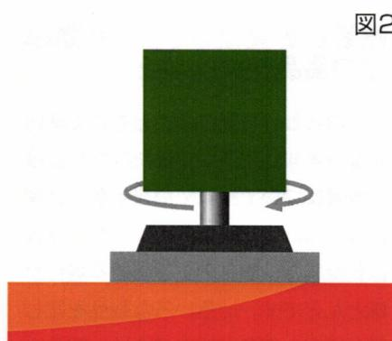
ポリッシャーをフラットに置き、ボカシ際の上で正回転させると、ボカシ際から根元側に向かって塗膜がねじれる
