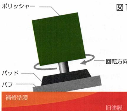
補修塗膜のボカシ際ではなく根元側に荷重をかけ、ポリッシャーを正回転させれば、ボカシ際のクリヤーはめくれにくく
