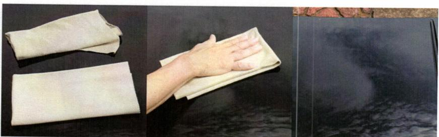
コーティング剤塗布後の拭き上げは、粗拭き用と仕上げ用とでクロスを分けて行うとムラが残りにくい
