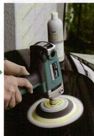
バフ目が戻ることへの対策として、コンパウンドを超微粒子タイプに換え、仕上げ用の羊毛バフで磨く
