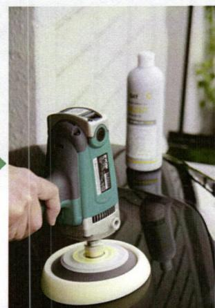
スポンジバフで磨いて完全に仕上げる。数時間後、濡れたクロスで拭き上げ、バフ目の戻りなどが発生していないことを確認したら、作業完了
