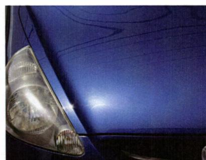
磨き作業が完了し完全に仕上がった、脱脂前の塗膜
