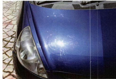
左の車両を脱脂した後の塗膜。ワックスで隠されていた洗車傷などが露わになっている
