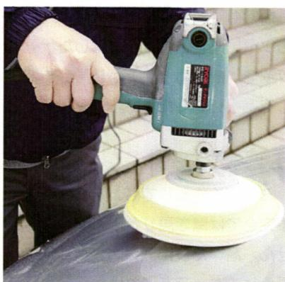
ペーパー目を素早く消す方法の一つ、バフを斜めに強く当ててバフの角にトルクを集中させる磨き方
