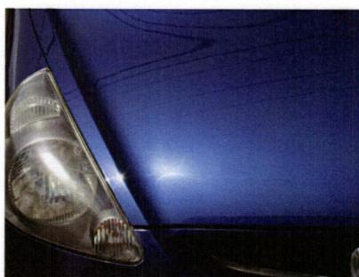
ポリマー系ボデーコーティング剤施工後。脱脂後に見えていた傷が埋まっている
